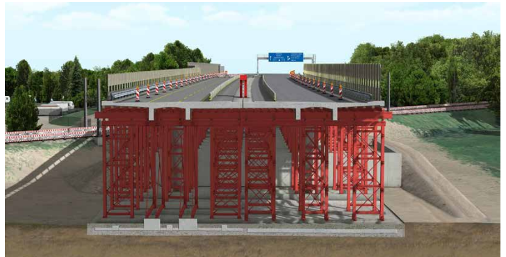
Aufschnitt einmal anders: Die Gerüstkonstruktion der Dütebrücke mit Stahl von ArcelorMittal
